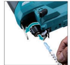
con un porta cuchillas que permite el cambio de cuchillas con una sola mano
